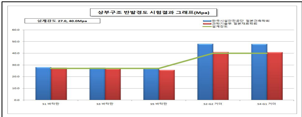
【그림 3.4.3】 상주방향 상부구조 반발경도시험 측정결과
