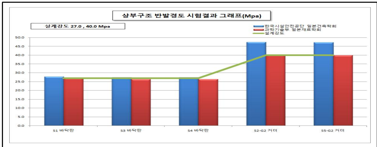
【그림 3.4.5】 영천방향 상부구조 반발경도시험 측정결과
